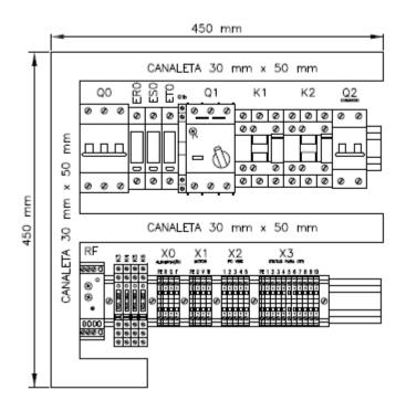
01 Painel elétrico nas dimensões mínimas de LAP: 500x500x300 mm, sem visor, IP 66, NEMA 4X com os equipamentos descritos abaixo, devidamente montados e interligados:
