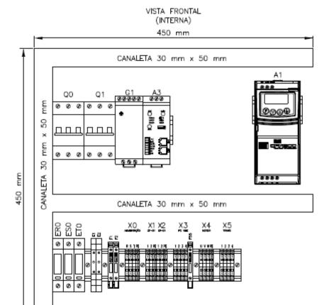
01 Painel elétrico nas dimensões mínimas de LAP: 500x500x300 mm, sem visor, IP 66, NEMA 4X com os equipamentos descritos abaixo, devidamente montados e interligados:
