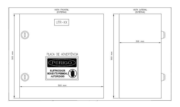
01 Painel elétrico nas dimensões mínimas de LAP: 500x500x300 mm, sem visor, IP 66, NEMA 4X com os equipamentos descritos abaixo, devidamente montados e interligados:
