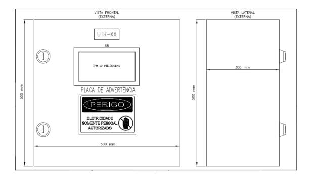
01 Painel elétrico nas dimensões mínimas de LAP: 500x500x300 mm, sem visor, IP 66, NEMA 4X com os equipamentos descritos abaixo, devidamente montados e interligados:
