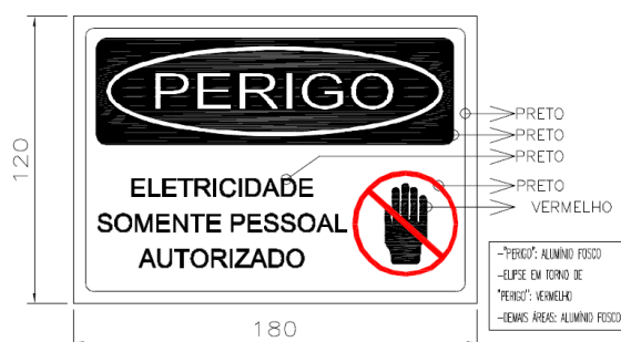
Figura 1 – Placa de Advertência de Risco Elétrico.
